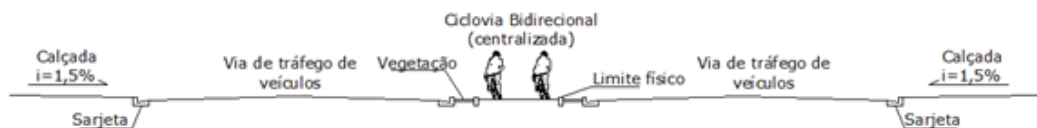
Figura 6: Corte esquemático da Ciclovia Bidirecional Centralizada
