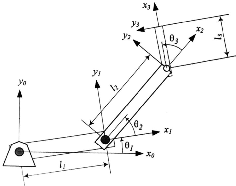
Figura 6: Colocação do sistema de referência, no mecanismo do tipo 3R
