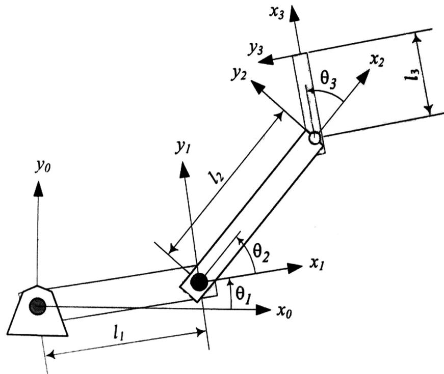
Figura 5: Colocação do sistema de referência, no mecanismo do tipo 3R
