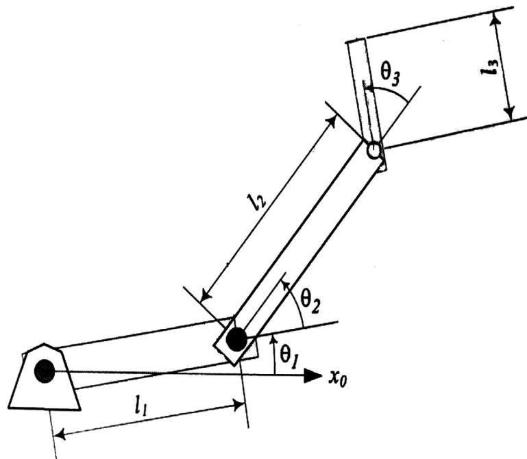
Figura 4: Mecanismo do tipo 3R
