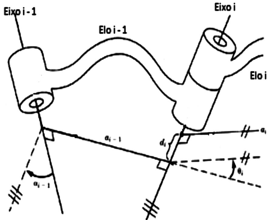
Figura 2: Conexão de elos
